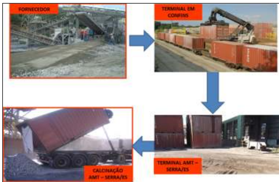
Figura 4.8 – Operação de transporte de calcário em contêiner
