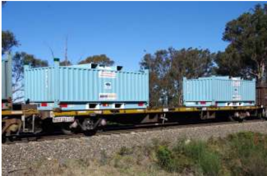
Fonte: Australian Container Leasing (2011) Figura 2.4 – Container de 20 pés do tipo open top especial
