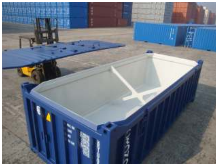
Fonte: Cronos Group (2011) Figura 2.3 – Contêiner de 20 pés do tipo halph height
