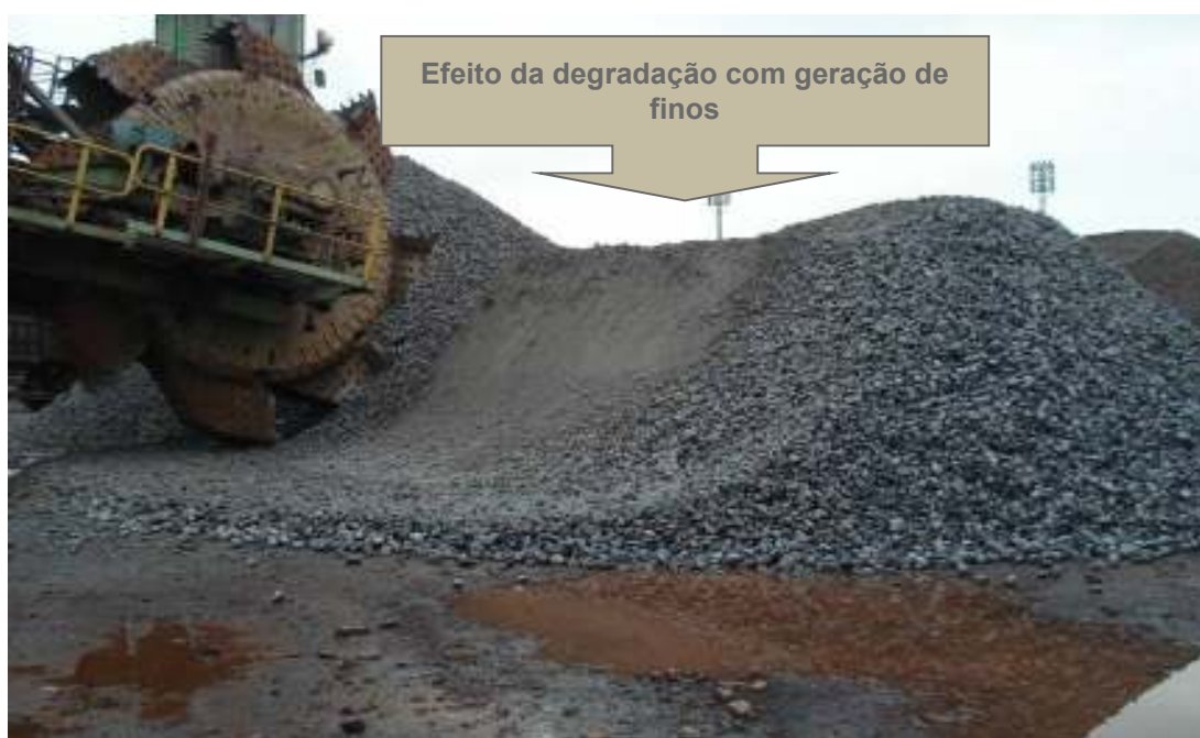
Fonte: Silva et al. (2011) Figura 4.3: Exemplo da degradação do calcário
