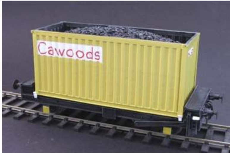
Fonte: Cawoods Container Services Limited (2011) Figura 2.2 – Contêiner de 20 pés do tipo Open Top
