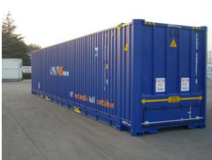
Fonte: Cronos Group (2011) Figura 2.1 – Contêiner 40 pés do tipo bulk .
