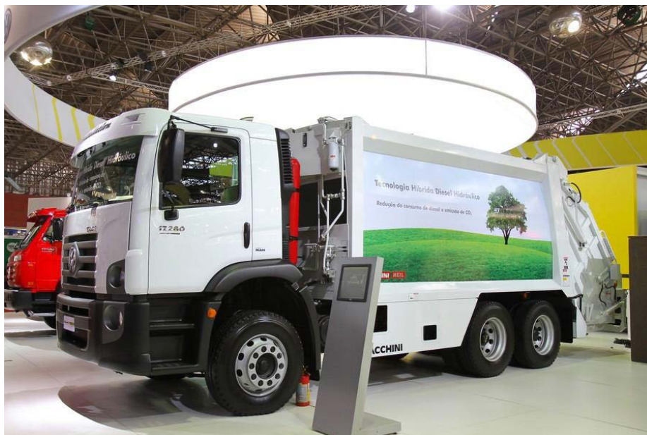
Figura 31: Caminhão VW 24.280 com sistema de propulsão híbrido diesel hidráulico HRB Fonte: MAN LATIN AMERICA
