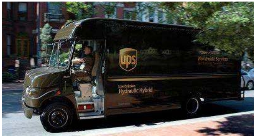
Figura 29: Caminhão equipado com um sistema de propulsão híbrido hidráulico em série Fonte: Bohlmann (2007)
