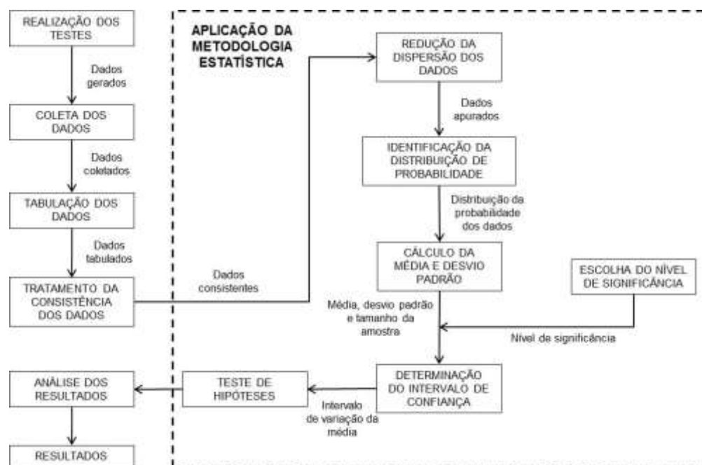
Figura 2: Diagrama com síntese do procedimento e metodologia estatística de avaliação das medidas de rendimento do combustível e opacidade dos gases de escapamento dos motores.
