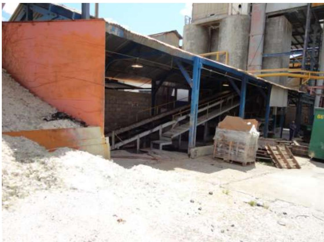
**Figura 3:** Esteira para transporte do caco que alimentará o forno.
