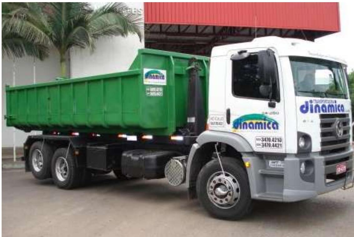
**Figura 5:** Caminhão com sistema roll on roll off.
