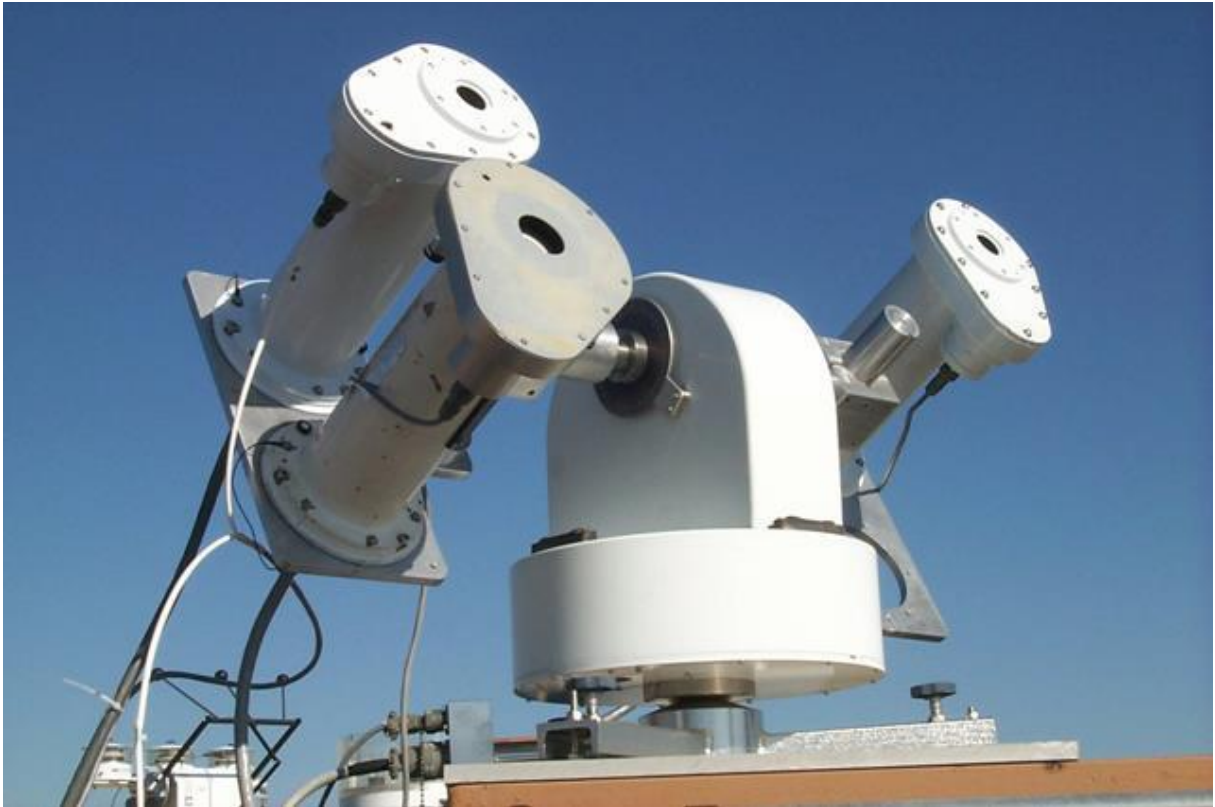
Figura 4: Imagem de um pireliômetro Fonte: NREL – National Renewable Energy laboratory
