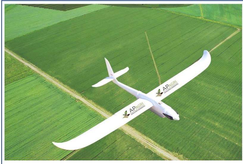
Figura 2.2.1 Exemplo de VANT de asa fixa
