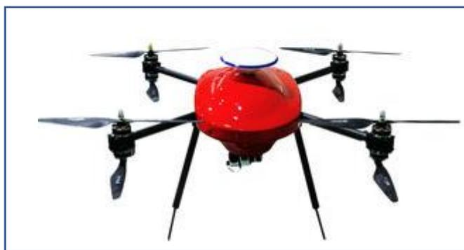
Figura 2.2.2 Exemplo de VANT de asa rotativa ou multirotor
