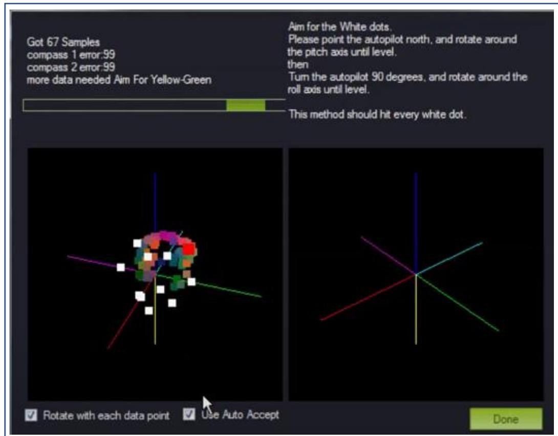
Figura 4.2.2 - Processo de leitura de dados durante a calibragem da bússola
